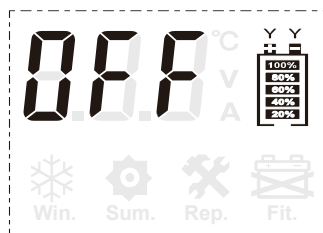
Ladingen stopper automatisk etter 2 timers lading.
