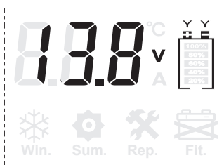
Batteriladdans ikon blinkar och batteriet känns inte igen.
