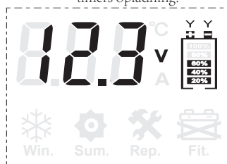
Under normal opladning blinker batteriniveauet sekventielt. Blinker, strøm, spænding og rumtemperatur vises efter tur.
