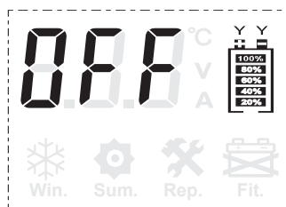
Opladningen stopper automatisk efter 2 timers opladning.
