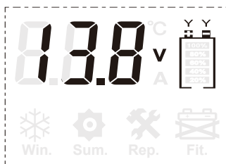
Batteriboksisikonet blinker og batteriet gjenkjennes ikke.
