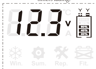
Under normal lading blinker batterinivået sekvensielt. Blinker, strøm, spenning og romtemperatur vises etter tur.
